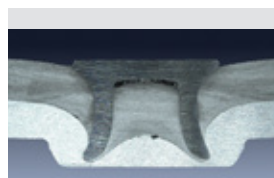
Imagem de corte transversal de uma união com rebite puncionado semi-oco.
