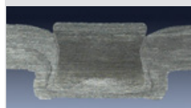
Imagem de corte transversal de uma união ClinchRivet®.
